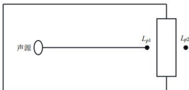
图 4-5 室内声源等效为室外声源图例
